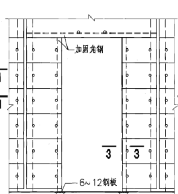
外墙横板门洞角钢加强立面图
