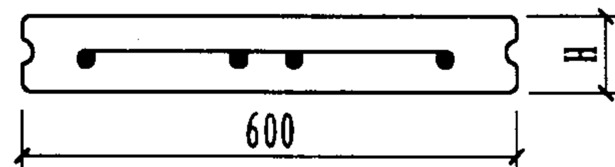
断面配筋 (单筋)
