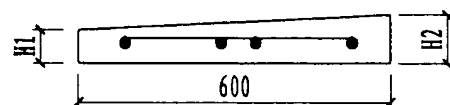
断面配筋 (单筋)
